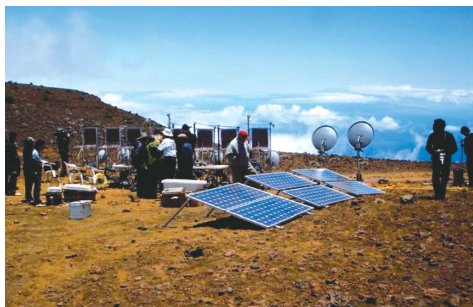
図3 マウイ島の送電アンテナシステム。太陽電池で発電された電力をマイクロ波に変換して8台の小型アンテナから、遥か離れたマウナロア山に向けて送電
