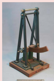
ワルテンホーフェン氏振子 銅製の振子の振動に対する磁場による制動効果を示す装置
