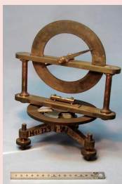
傾角計 地磁気の傾角の測定器
