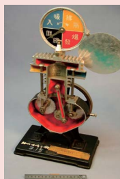
内燃機関裁断装置 内燃機関の動作を説明するための模型
