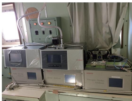
図2 深江丸海洋観測室に設置した大気質分析測定装置。全て、大阪市、大阪府、兵庫県の環境研究所所有のもの
