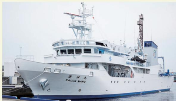
全長：約59.60m、幅：11.00m、深さ（船楼甲板）：6.70m、総トン数：約892t、最大搭載人員：65名
