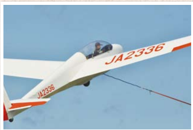
エンジンを持たないので、飛行機やウインチで上空まで曳航してもらい離陸。その後、上昇気流をもらって飛行する。初フライトは本当に感動!
