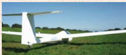
エンジンを持たないので、飛行機やウインチで上空まで曳航してもらい離陸。その後、上昇気流をもらって飛行する。初フライトは本当に感動!
