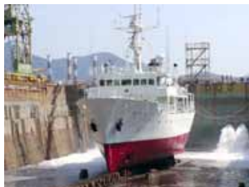
図3 ドライドック注水（船体浮上）風景
