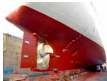
図2 外板整備後の右舷船尾船底部
