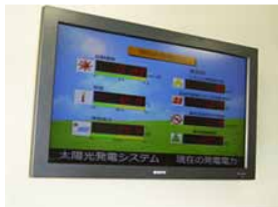
太陽光発電システム表示パネル
