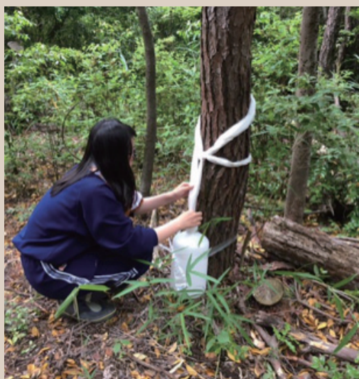
写真1 幹にガーゼを巻いて樹幹流を採取する準備をしている
