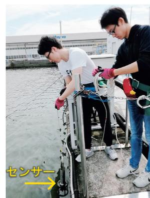
図3 基礎ゼミ生による水質の鉛直分布測定
